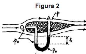
Se  $\rho$  é a densidade no ponto A,  $\rho_0$  é a densidade do fluido no tubo em forma de U e  $h$  a diferença de nível entre os dois ramos, a velocidade  $v$  do escoamento do fluido é descrita como:
