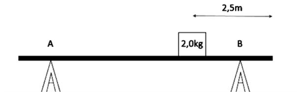
A figura representa uma prancha homogênea de massa igual a 9,0kg e 8,0m de comprimento apoiada em dois suportes A e B, simetricamente dispostos e afastados a uma distância de 1,0m das extremidades e que suporta um bloco de 2,0kg a uma distância de 2,5m da extremidade direita.
